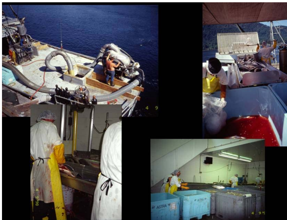
Figur 3. Semimodern slaktkedja, vilket är typiskt för större grupper av odlare i Sverige och i Finland. Fisken transporteras och pumpas i vatten. Bedövning med CO 2 med manuell strupskärning och urblödning i stillastående vatten. Semimanuell rensning och manuell sortering.
