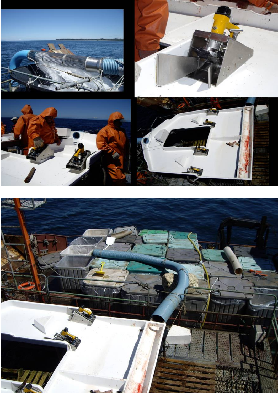
Figur 6. Ett exempel på ett litet transportabelt slaktsystem med stämpel. Fisken pumpas upp på slaktbordet och förs manuellt in i stämpeln innan den släpps vidare till strupskärning i ändan av bordet. Systemet kan enkelt kompletteras med utrustning för bloduppsamling.
